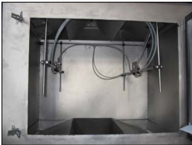
Dettaglio interno della camera di umidificazione con gli ugelli.
